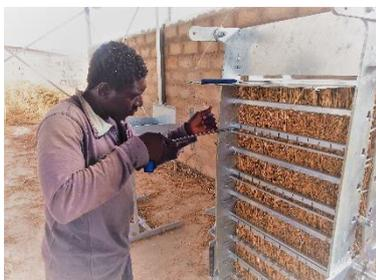
In dieser Abbildung sieht man, wie das Stroh in einem Pressrahmen von Hand mit Jutegarn abgesteppt wird. Die Herstellung erfolgt vom Sammeln des trockenen Grases bis zur Verpackung komplett in Gambia. Es entstand dort mittlerweile ein eigenständiges ISOCALM Ltd. - Unternehmen in gambischer Verantwortung. Für den Vertrieb in Deutschland wurde das Vertriebsunternehmen *ISOCALM GmbH* in Schorndorf gegründet.
