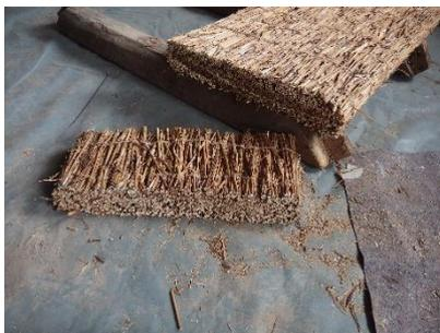
Herkömmliche Schilfrohmatten müssen hingegen immer mit einer Zange oder ähnlichem durchgezwickelt werden. Den Zuschnitt der *ISOCALM* Platten haben wir akkurat mit einer Hand-Flex hergestellt. Wir waren von den geraden Schnittkanten beeindruckt. Ohne Abfall konnte die Dämmplatte verarbeitet werden, ohne Lücken oder Fehlstellen in der Dämmebene aufzuweisen
